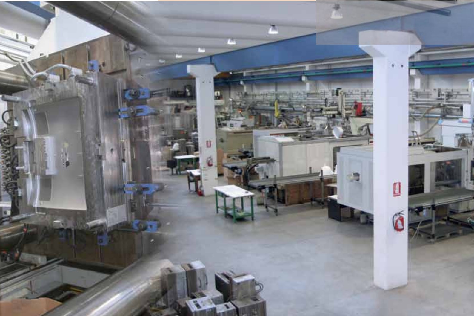
Presse da 100 A 1400 TON dotate di manipolatore nastri e deumidificatori per il trattamento dei tecnopolimeri
